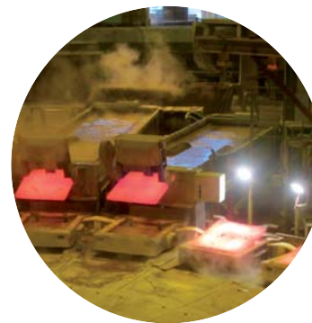
Vasemmallla: Anodien nostimet, joilla esijäähdytetyt anodit nostetaan varsinaisiin jäähdytyslaitteisiin. Keskellä: Punnitsevut valukipit, joiden ansiosta pystytään valamaan tarkasti samanpainoisia anodeita. Oikealla: Kuparisulaton virtauskaaviota.
