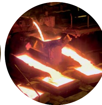
Vasemmallla: Anodien nostimet, joilla esijäähdytetyt anodit nostetaan varsinaisiin jäähdytyslaitteisiin. Keskellä: Punnitsevut valukipit, joiden ansiosta pystytään valamaan tarkasti samanpainoisia anodeita. Oikealla: Kuparisulaton virtauskaaviota.
